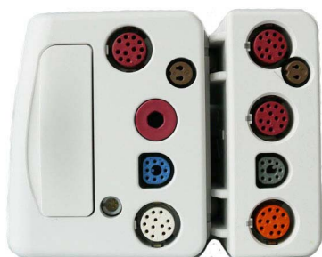
Pasientmodulen M3014A festet til X2-modulen
