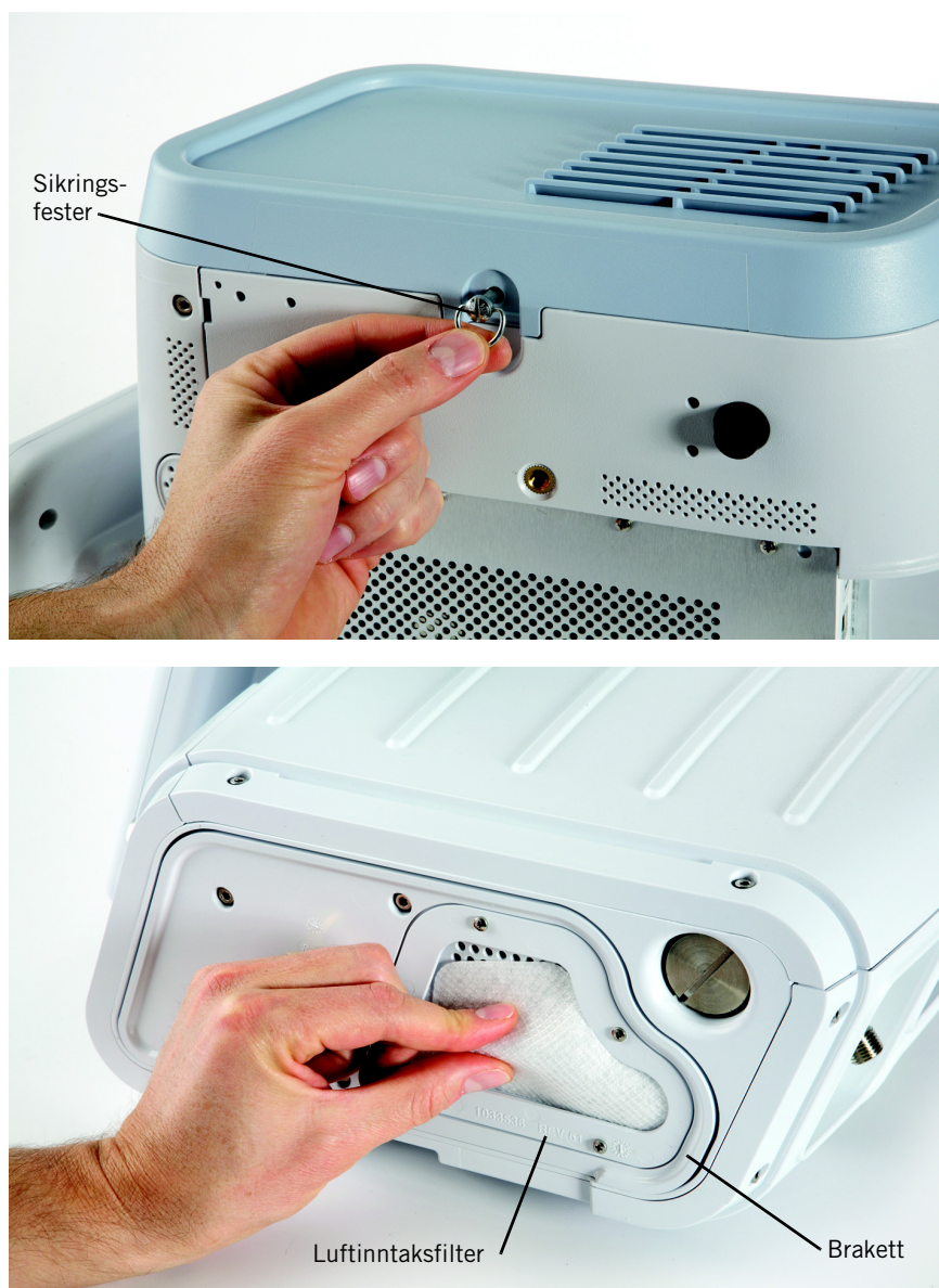
Figur 10-1: Skifte ut luftinntaksfilteret
