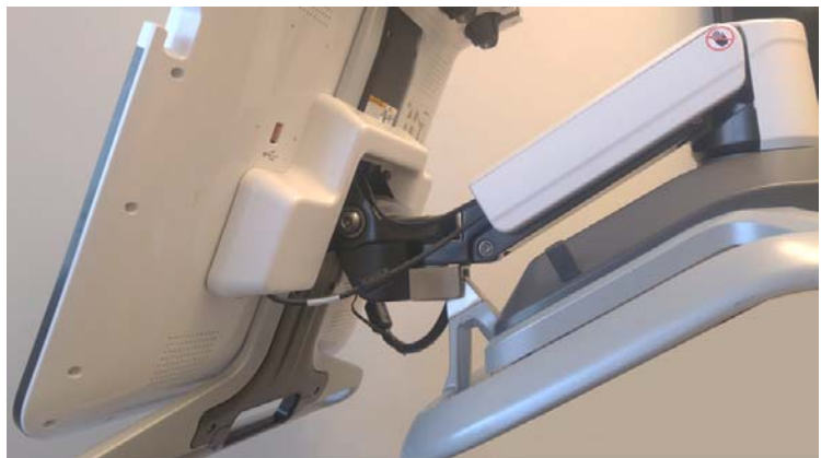
Figur 3-12. Skjermarm vist i låst posisjon
